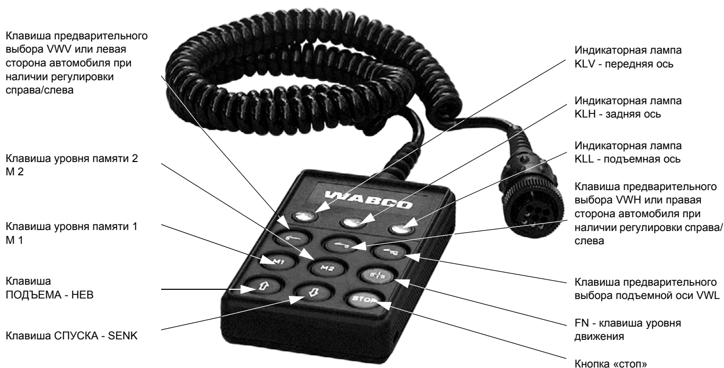
Рис. 32 Блок управления 446 056 117 0 и его компоненты
